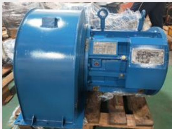
Traction Motor Blower Fan
