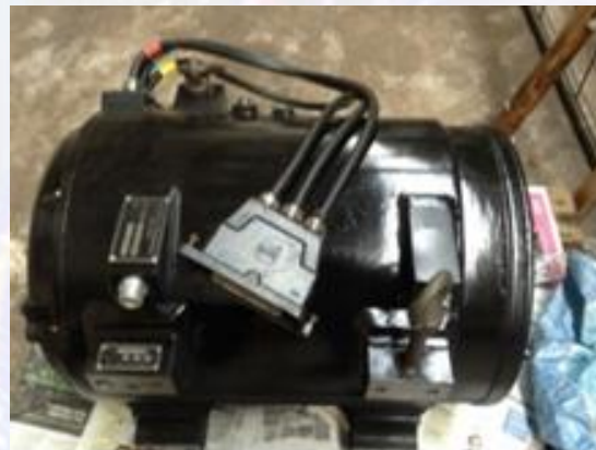
ERL Traction Motor (230kW)
